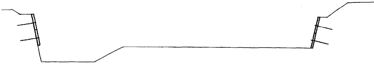
1 - Terrassement et soutènement par paroi clouée
