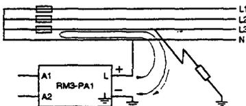
Une tension continue (borne L) est appliquée entre une phase (ou le neutre s'il existe) de l'installation et la terre (borne N). Dès qu'un défaut d'isolement à la terre se présente, il se traduit par l'apparition d'une résistance non infinie, entre l'installation et la terre. Un courant de défaut s'établit et celui-ci traverse alors cette résistance dite "d'isolement".
