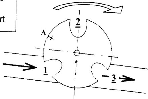
Le plateau d'alimentation et d'éjection est séparé en trois postes régulièrement répartis. Pour passer un roulement du poste 1 au poste 2 le vérin rotatif 4C provoque un mouvement en 3 phases décrites ci-dessous :
