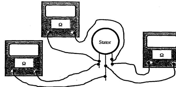
Indiquez, sur les ohmmètres, les valeurs correspondantes aux mesures d'un stator en bon état.
