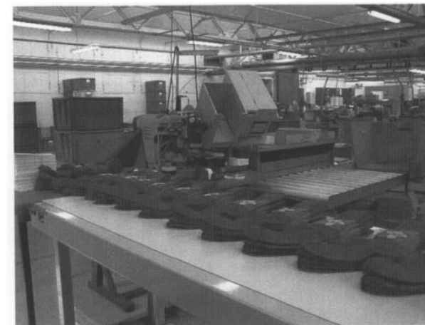
"MULTIJOB": zone d'étiquetage, de mise en boîte et de marquage des boîtes
