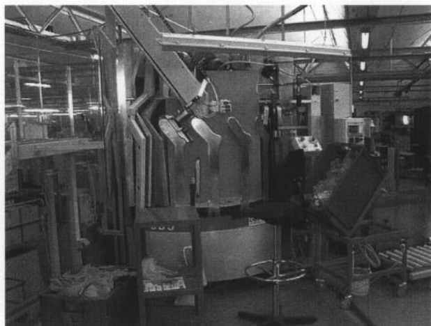
"MULTIJOB": zone d'enfilage des chaussettes sur les gabarits et contrôle après formage
