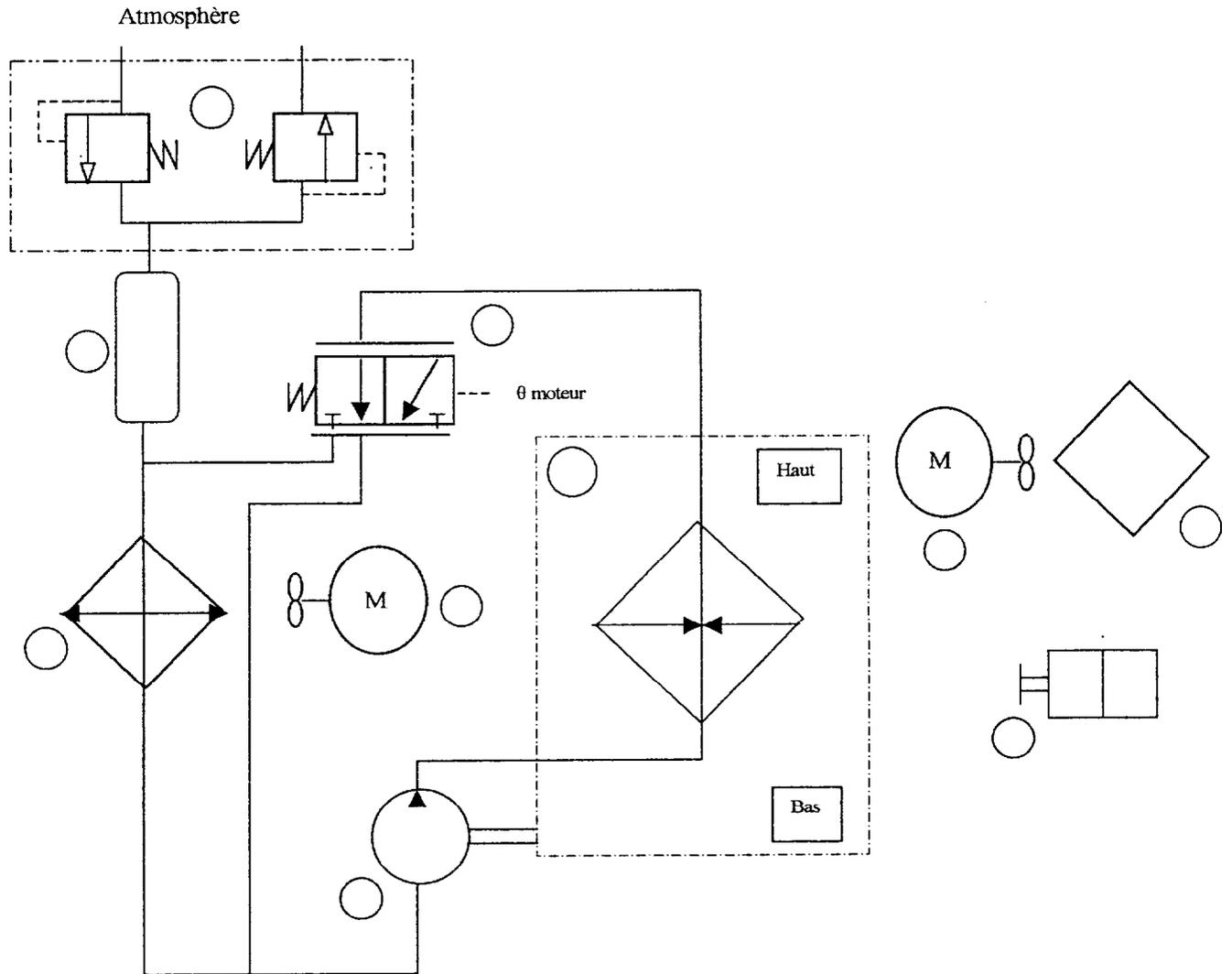
**Schéma normalisé du circuit de refroidissement moteur et de réchauffage de l'habitacle avec adaptation du réchauffeur WEBASTO.**
