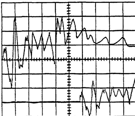
Sachant que la base de temps de l'oscilloscope est réglée à 0,5 ms/division, retrouver la vitesse de propagation du son dans l'air dans les conditions de l'expérience.
