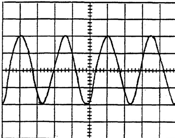
Sachant que la base de temps de l'oscilloscope est réglée à 10  $\mu$ s/division, retrouver la fréquence de l'onde émise par E.
