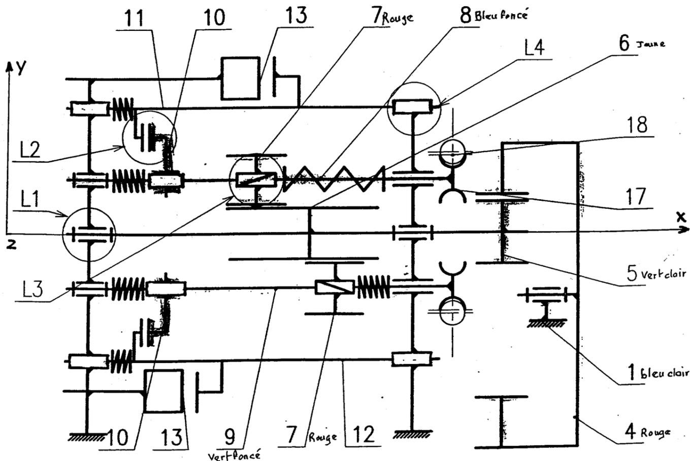
4/ La chaîne cinématique qui transmet le mouvement moteur de la couronne 4 au poussoir de montée 12 est constitué des pièces 4 – 5 – 6 – 7 – 10 et 12. /1
