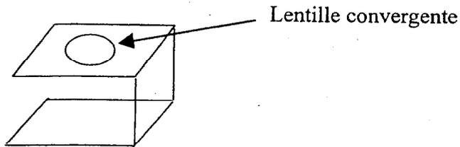
Le compte fils schématisé ci-dessus est un objet utilisé en imprimerie. Il permet la visualisation de la trame d'un document en grossissant celui-ci. Il est constitué d'une lentille simple convergente.
