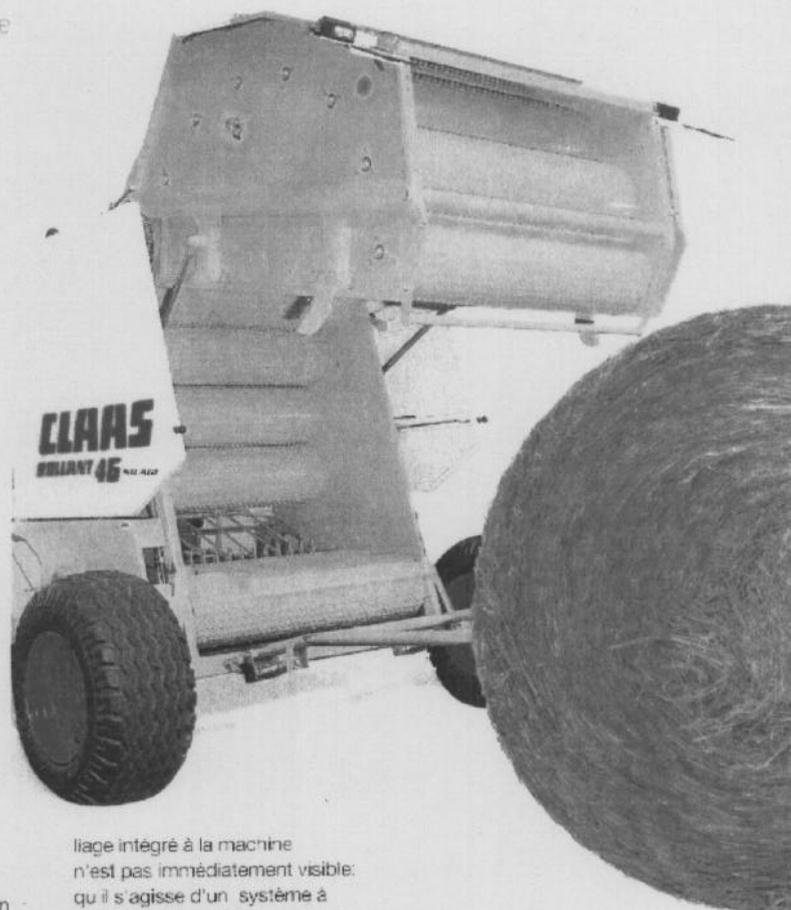
La ROLLANT 66 et la ROLLANT 46 (également disponible dans une version équipée du système ROTO CUT) rencontrent un grand succès. Ce sont des presses à balles rondes à chambre de compression en acier, au gabarit très compact, à habillage rabattable lisse. Le système de
