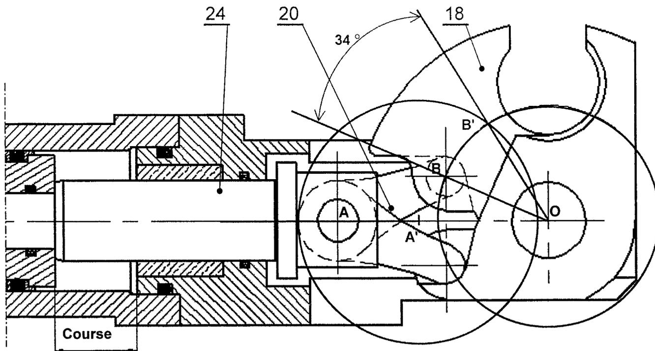
Une mauvaise position des contacts de fin de course peut provoquer un déplacement insuffisant de l'axe du vérin et donc une rotation insuffisante des couteaux. Il faut alors vérifier la position de A et C. La distance (d) entre A et C doit être comprise :  $30 < d < \text{course} = 40$ .
