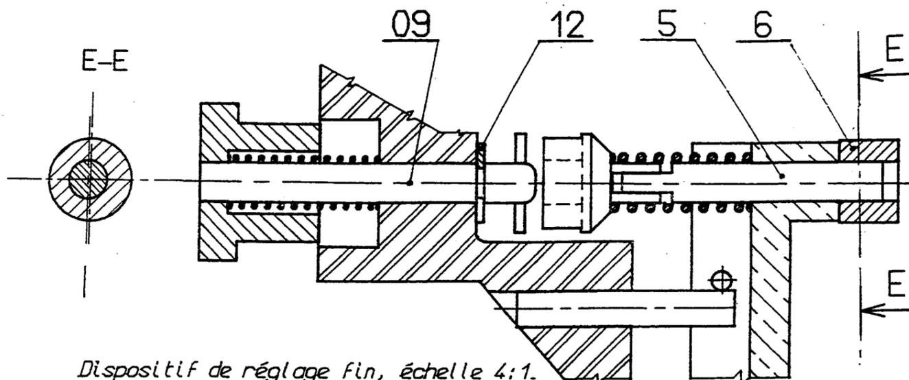
Dispositif de réglage fin, échelle 4:1.
