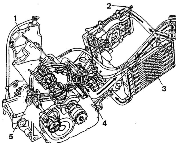
Schéma de principe du circuit de refroidissement
