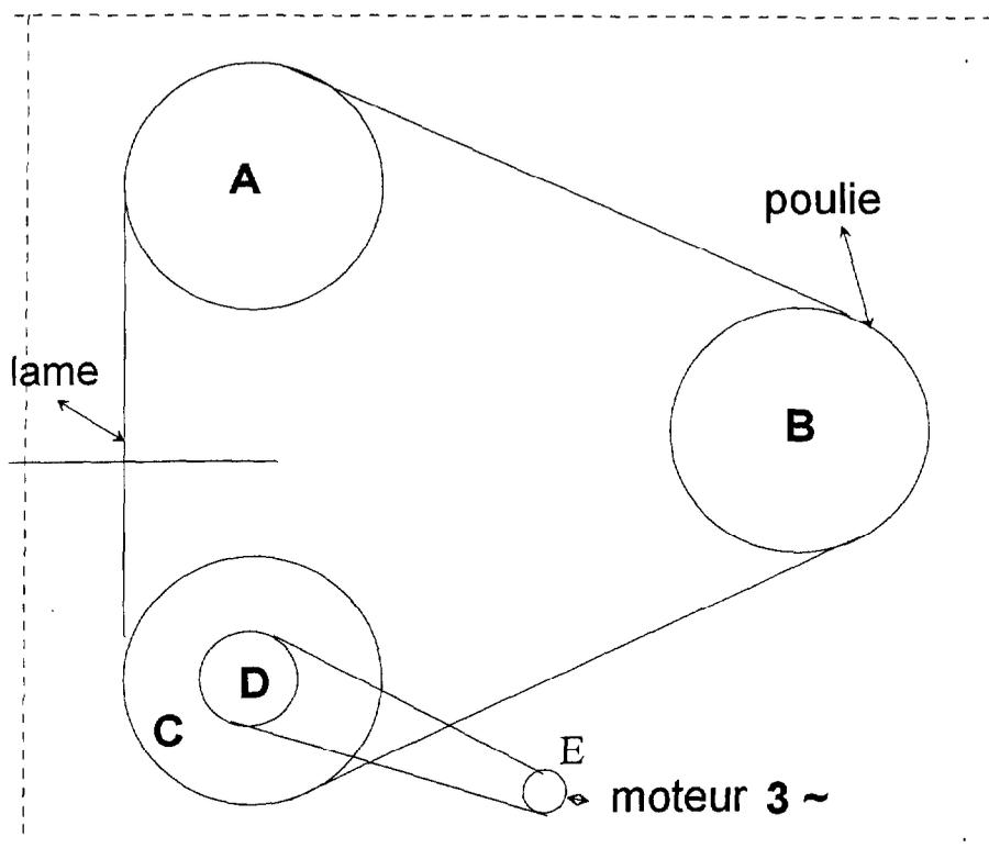
Cette machine comporte 3 poulies (A, B et C) de 30 cm de diamètre et une lame d'acier qui encercle ces poulies et assure la découpe des matelas.
