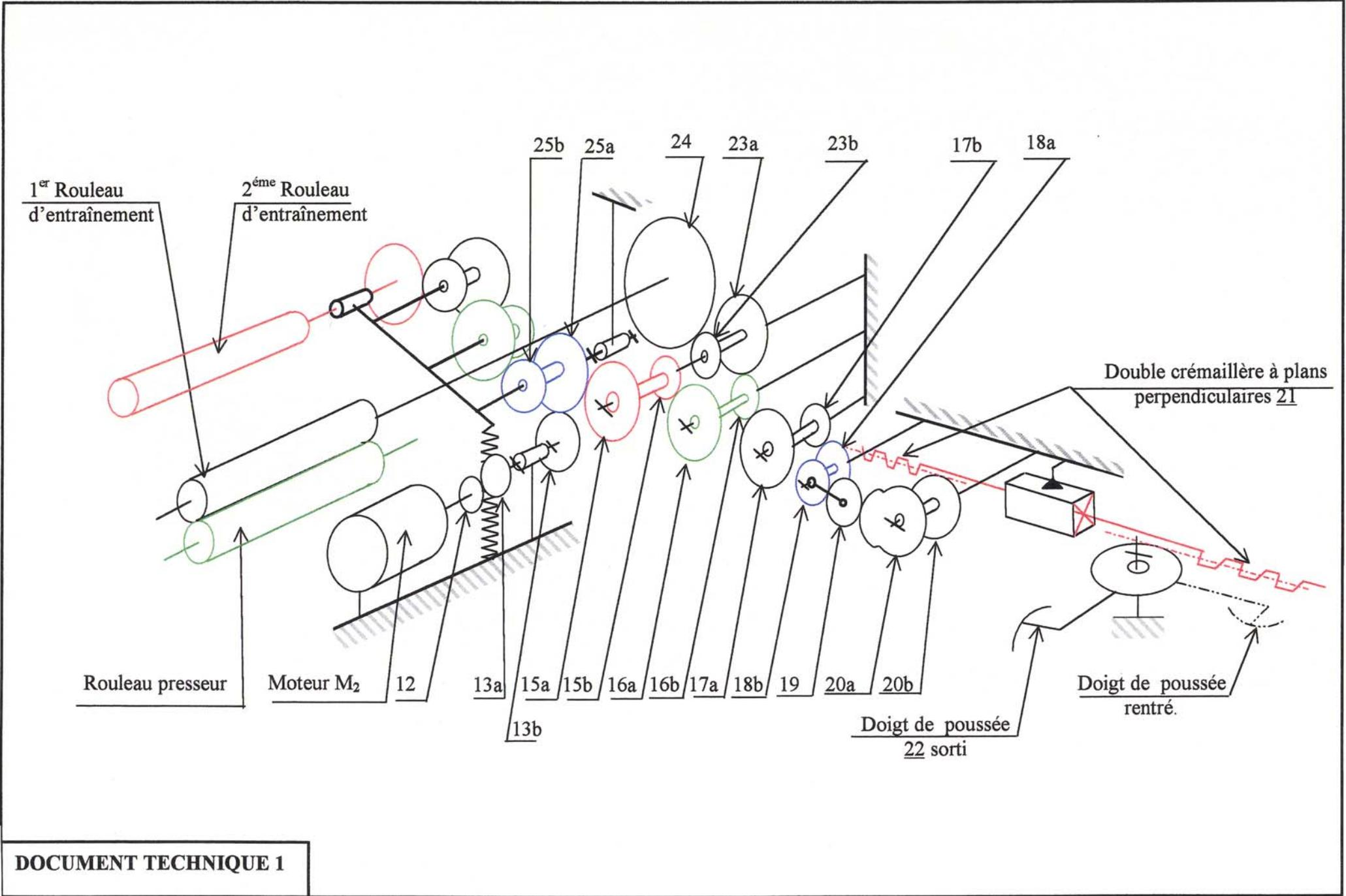
Nota : les mobiles 15 et 23 sont montés sur le même axe.
