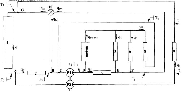
L'ensemble du système de refroidissement comporte 8 échangeurs thermiques (voir **DT 2/14 et DT 3/14**). La figure ci-dessus représente le même circuit de refroidissement dans le cas particulier d'un fonctionnement où on n'utilise pas le radiateur de chauffage de la cabine 4 et pour un tombereau non équipé du filtre du liquide de refroidissement 7.
