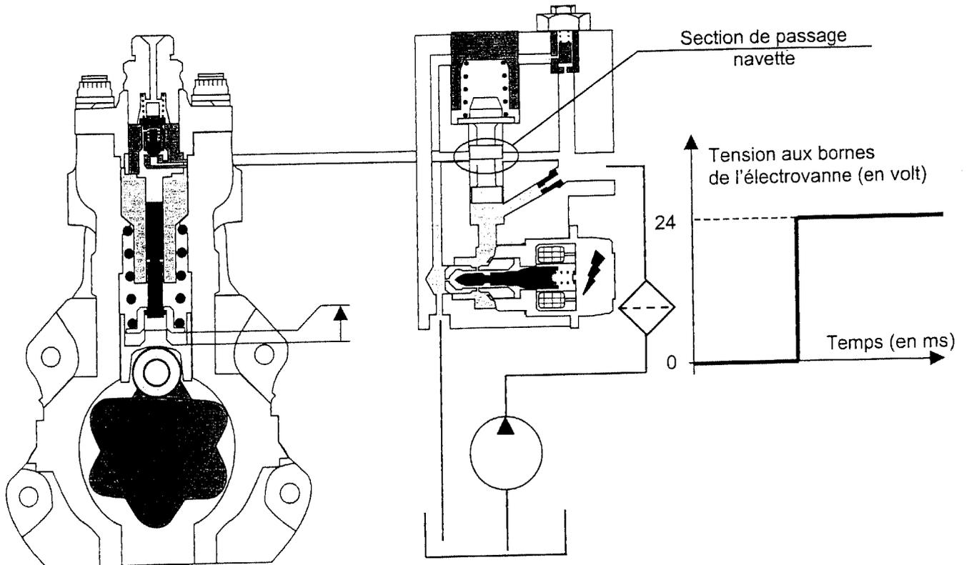
En fonction du rapport cyclique de commande de l'électrovanne, la position de la navette sera modulée, et donc le débit qui passe à travers le boîtier de dosage qui alimente l'élément de pompe (tête hydraulique).
