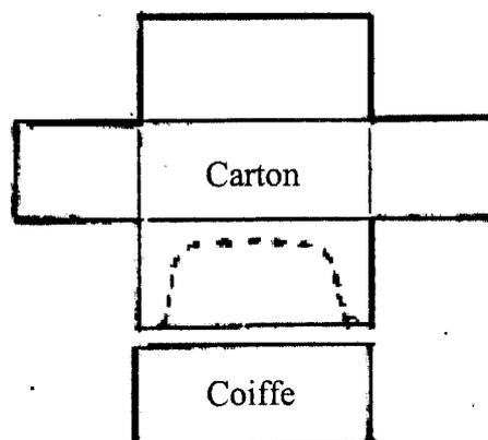
**Pour le calcul de la superficie de l'emballage**, rajouter 10 % de la surface totale calculée pour obtenir la surface réelle tenant compte des bords de la coiffe et des angles du carton à plier/coller.
