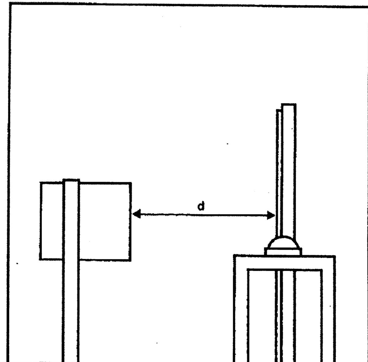
Châssis d'insolation et lampe 3000 W
