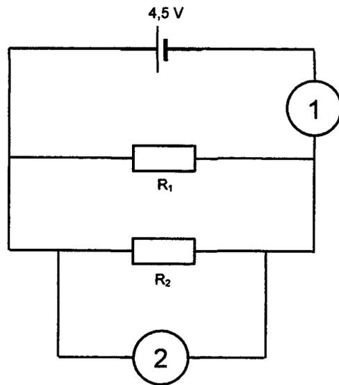
On appelle  $I$  l'intensité du courant débitée par la pile.  $I_1$  l'intensité du courant traversant le conducteur ohmique  $R_1$  et  $I_2$  l'intensité du courant traversant le conducteur ohmique  $R_2$ .
