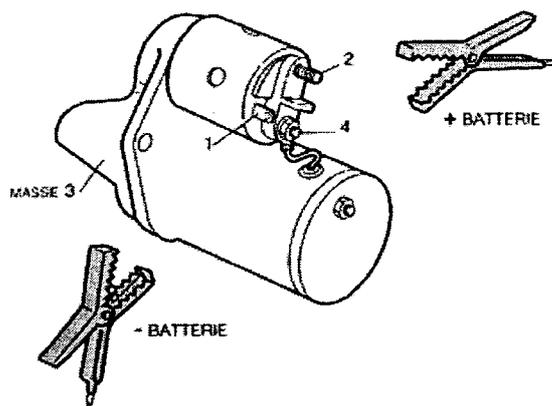
**Q34 : Placez les pinces d'alimentation afin de contrôler le bon fonctionnement du moteur électrique de ce démarreur**
