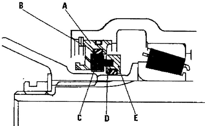
**PRINCIPE ET MONTAGE DU JOINT MAGNETIQUE**
