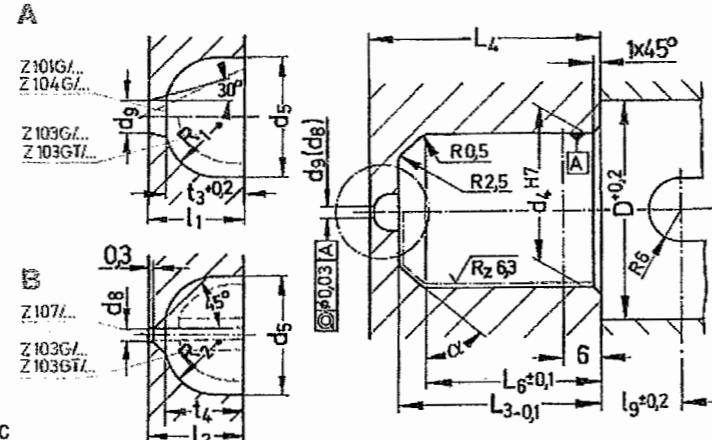
Die Maße für die Aufnahmebohrung sind der Tabelle zu entnehmen. Es ist zu unterscheiden nach einer offenen Anspritzung (A) oder dem Einsatz mit Nadelventil (B). Das Maß „L<sub>4</sub>“ muß aus Funktionsgründen eingehalten werden.
