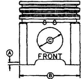
Remplacer l'ensemble piston et chemise si le jeu n'est pas conforme aux spécifications.
