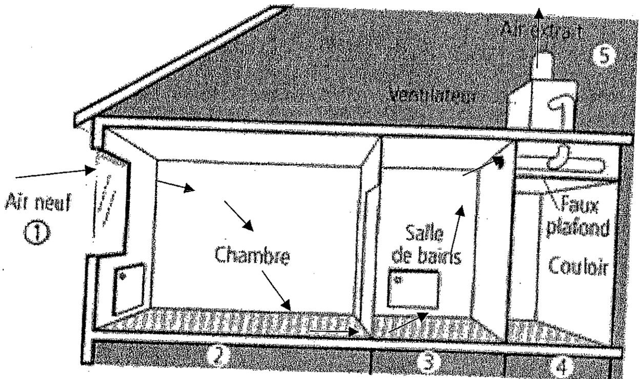
Titre: Schéma de principe d'une ventilation par simple flux (ou ventilation semi-mécanique)
