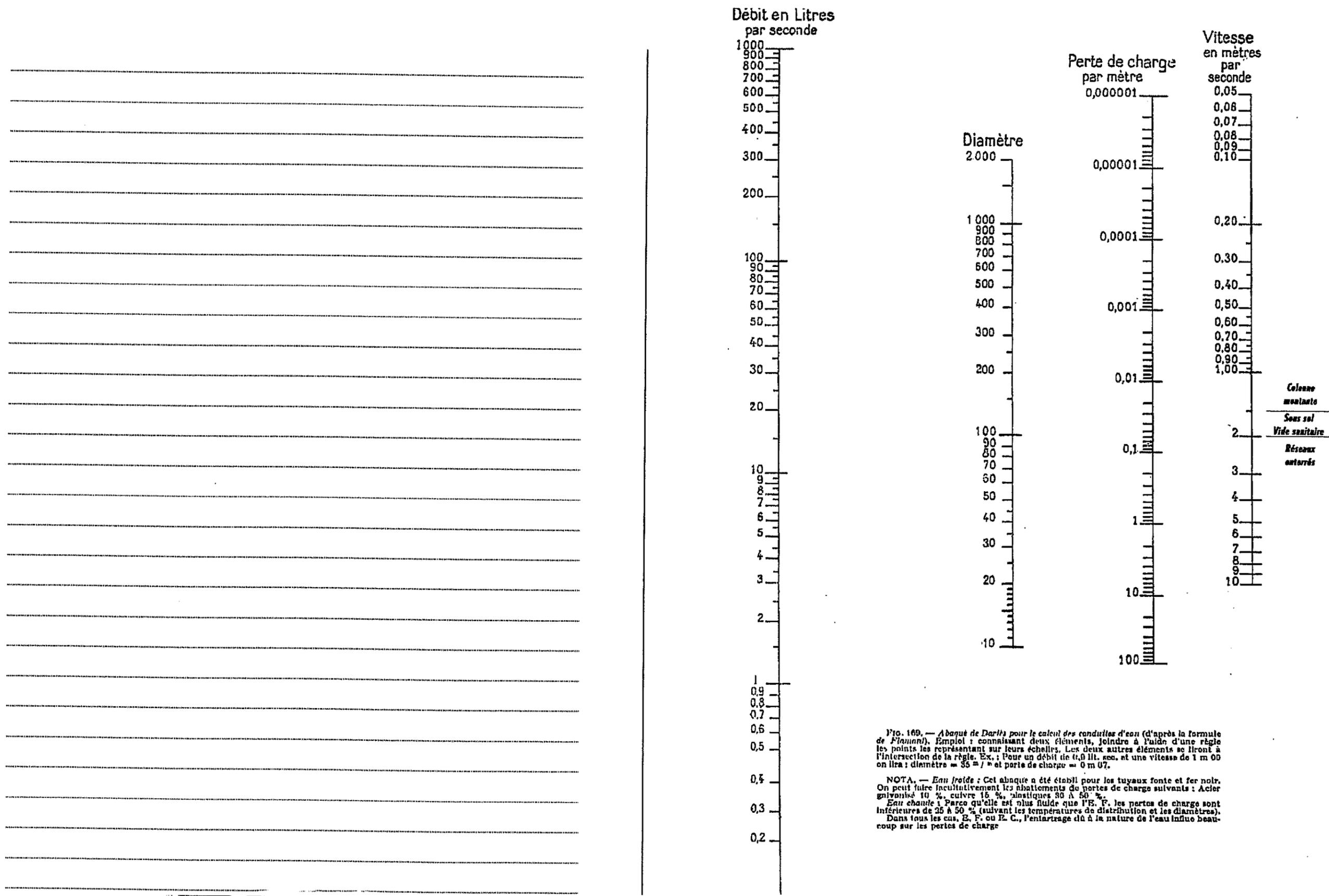
Fig. 169. — Abaque de Darius pour le calcul des conduites d'eau (d'après la formule de Hazen). Emploi : connaissant deux éléments, joindre à l'aide d'une règle les points les représentant sur leurs échelles. Les deux autres éléments se liront à l'intersection de la règle. Ex. : Pour un débit de 1,0 lit. sec. et une vitesse de 1 m 00 on lira : diamètre = 35 mm et perte de charge = 0 m 07.
