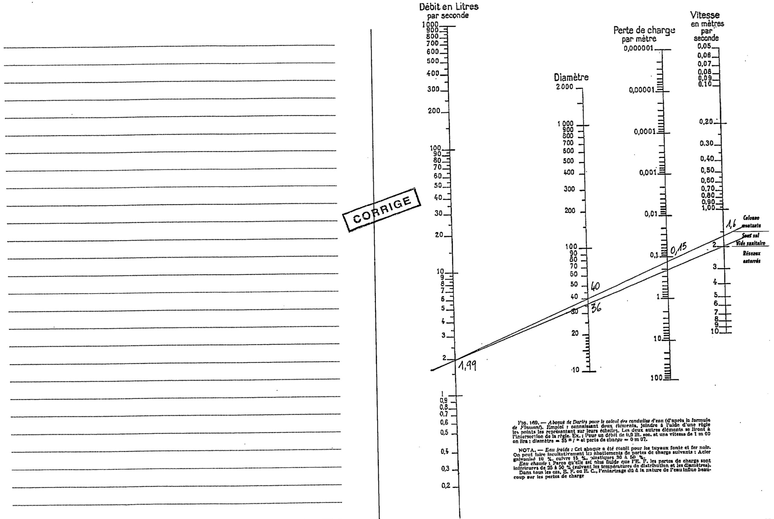
Fig. 169. — Abaque de Darius pour le calcul des conduites d'eau (d'après la formule de Plimpton). Emploi : connaissant deux éléments, joindre à l'aide d'une règle les points les représentant sur leurs échelles. Les deux autres éléments se liront à l'intersection de la règle. Ex. : Pour un débit de 10,0 lli. sec. et une vitesse de 1 m 00 on lira : diamètre = 85 mm et perte de charge = 0 m 07.
