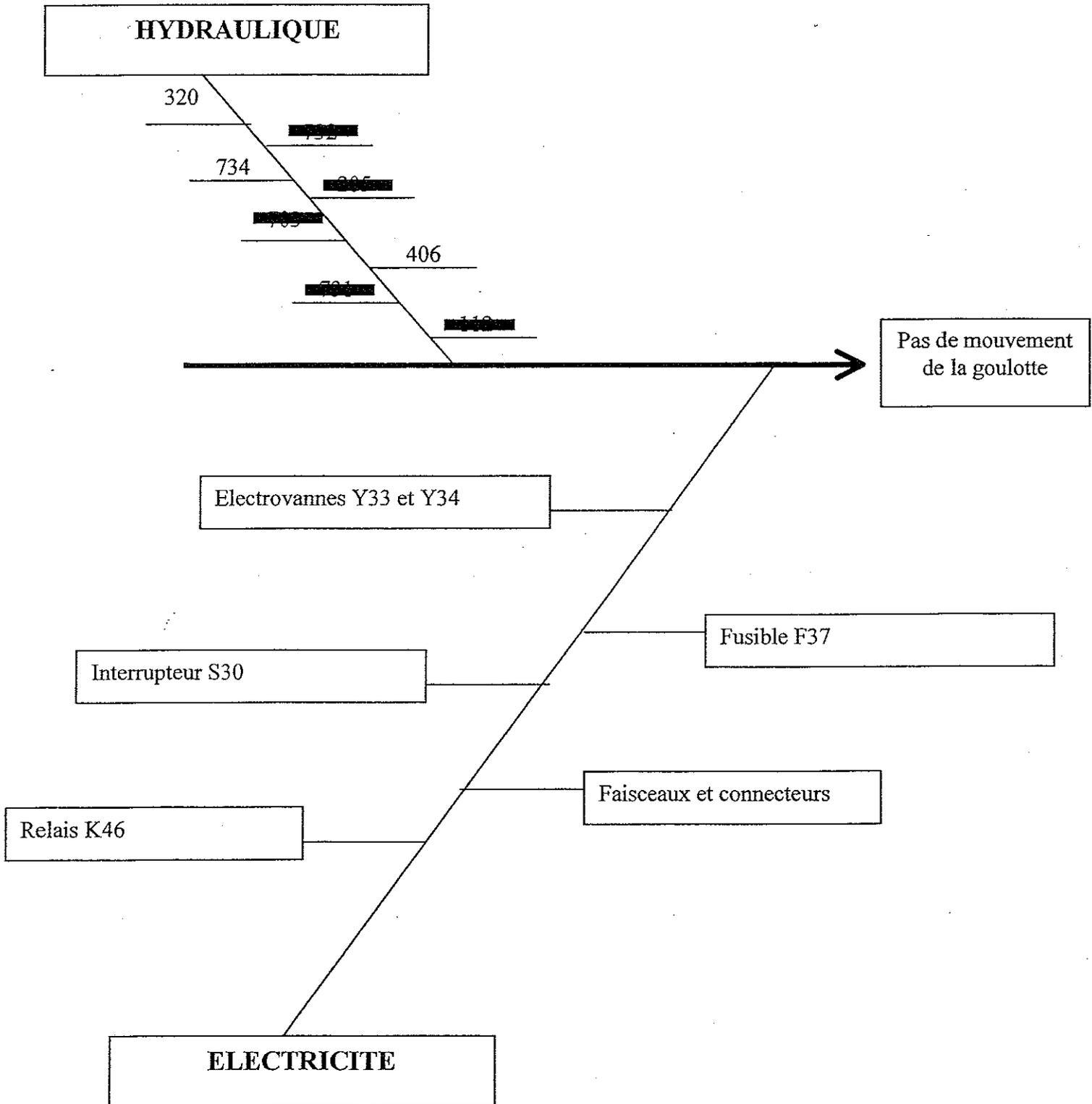
2° - Etablir la gamme opératoire vous permettant de contrôler la partie électrique du circuit de commande de la goulotte de vidange.
