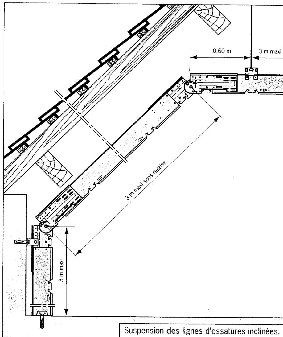
Les lignes d'ossatures inclinées sont reprises sur les pieds droits et sur les lignes d'ossatures horizontales.
