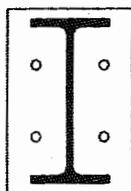
Liaison poutre - mur réalisée par 4 chevilles femelles type HKD - S
