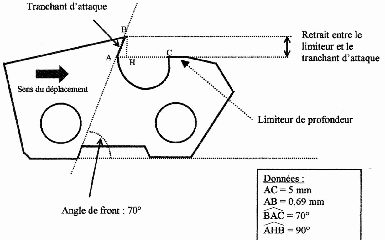
Le limiteur de profondeur détermine la pénétration dans le bois et, par conséquent, l'épaisseur des copeaux. Le retrait du limiteur de profondeur diminue lors de l'affûtage d'une dent. Le mécanicien doit alors respecter les distances  $BH$  et  $BC$ .
