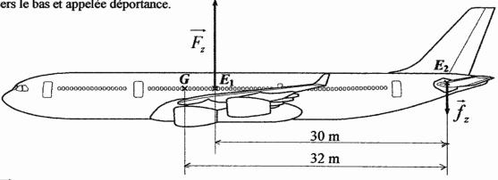
$\overrightarrow{F_z}$ : portance de point d'application  $E_1$ ,  $\overrightarrow{f_z}$ : déportance de point d'application  $E_2$ ,  $\overrightarrow{P}$ : poids de l'avion de point d'application G.  $\overrightarrow{F_z}$ ,  $\overrightarrow{f_z}$  et  $\overrightarrow{P}$  ont même direction.
