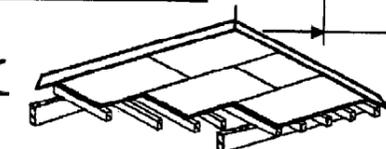
Détail d'un assemblage rainure - languette.
