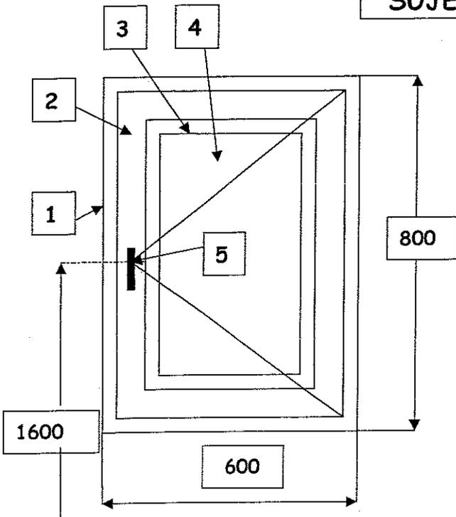
Un client ayant un châssis dans ses toilettes trouve que la ventilation du local est inappropriée. Le fabricant P.V.C. lui propose d'installer un limiteur d'ouverture, solution qui ne satisfait guère le client. Ils choisissent d'adopter la solution de transformer le système d'ouverture du châssis à la française en châssis oscillo-battant.
