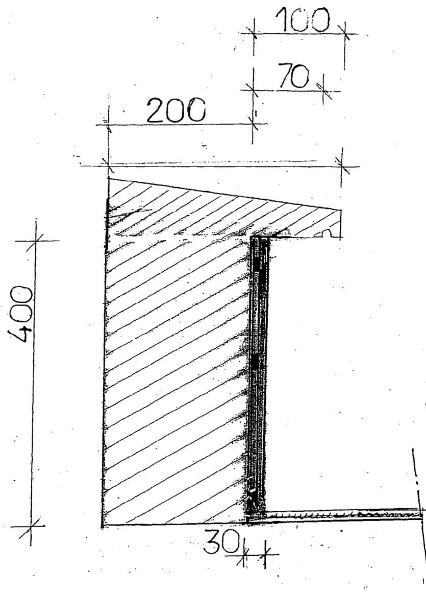
Réaliser un enduit grillagé sans talon sur un relevé de toiture terrasse accessible
