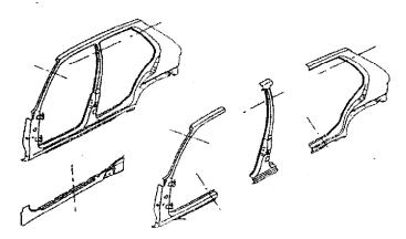
Remise en état d'une partie de structure de véhicule (bas de caisse, custode, pied avant, pied milieu, partie de longeron, traverse avant) par remplacement partiel, après tirage au sort d'un véhicule et de l'élément à travailler.
