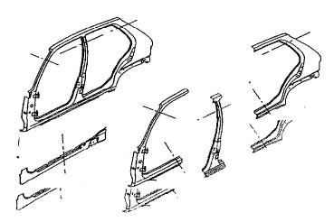
Remise en forme de la partie de structure de véhicule (bas de caisse, custode, pied avant, pied milieu, partie de longeron, traverse avant) du thème n° 1 par remplissage métallique de la ligne de soudure meulée (surface de remplissage de 5 à 8 cm). La distance entre les lignes de coupe est de 200 à 250 mm.
