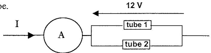
4.2.3 - Calculer, en A, l'intensité  $I$  du courant électrique principal. Arrondir le résultat à 0,01A. Les tubes sont considérés comme des dipôles purement résistifs.
