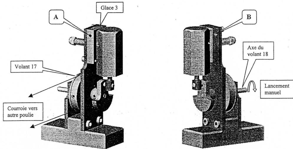
Ce petit moteur, utilisé pour des modèles réduits (bateaux, locomotives, ...), permet de transformer l'énergie de la vapeur sous pression en énergie mécanique.
