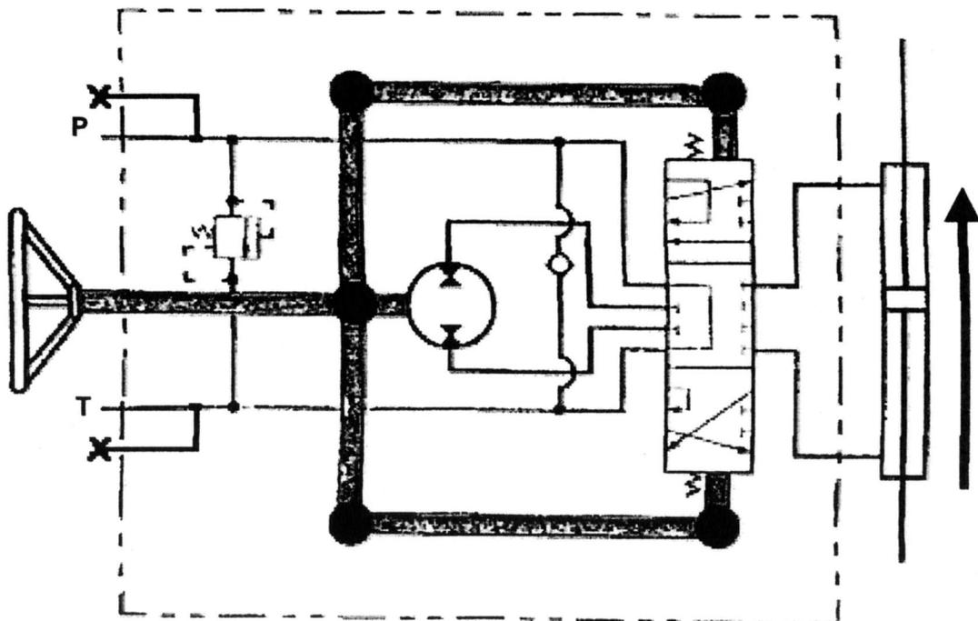
**Question 5.7 : Placer un manomètre sur le schéma afin de contrôler la pression maximum du circuit. Indiquer la valeur de tarage à obtenir.**
