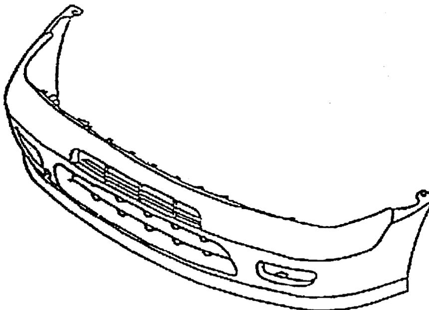
**Dépose et repose d'un bouclier avant monobloc sans accessoire.**
