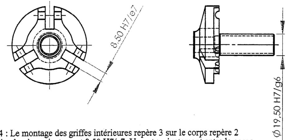
Activité 4 : Le montage des griffes intérieures repère 3 sur le corps repère 2 est réalisé grâce à un ajustement 8.50 H7/e7. Un autre ajustement entre le corps repère 2 et la coupelle d'appui repère 6 est nécessaire pour le bon fonctionnement de l'extracteur de roulements par inertie. A l'aide du dossier technique 4/5, complétez le tableau ci-dessous.
