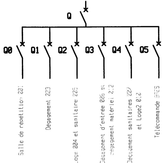
B21) Quel est le repère et la désignation de l'appareil protégeant la télécommande permettant de mettre les BAES à l'état repos lorsque les locaux sont inoccupés ?
