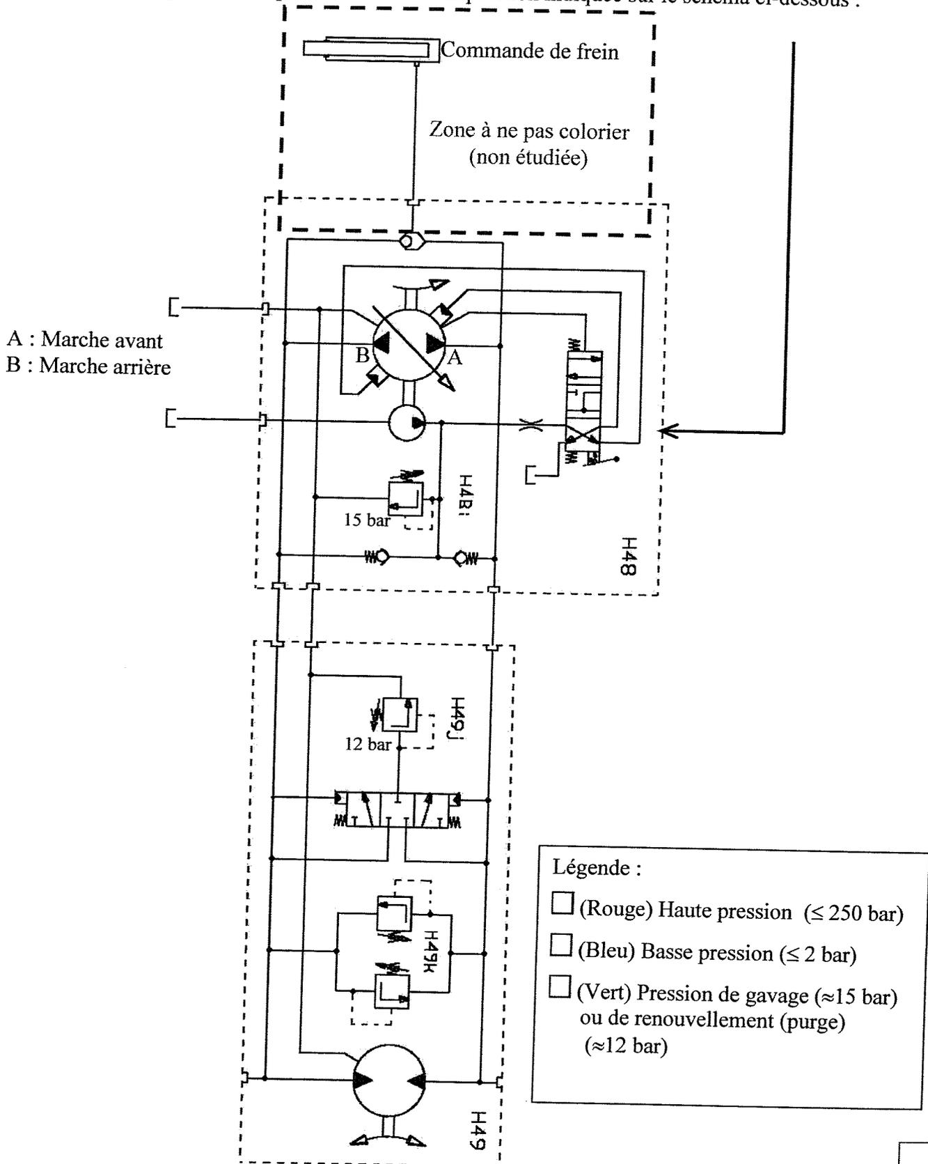
**Question 14 :** Sur le schéma ci-dessus coloriez en rouge le circuit de haute pression, en bleu le circuit de basse pression et en vert le circuit à la pression de gavage ou de renouvellement (purge).
