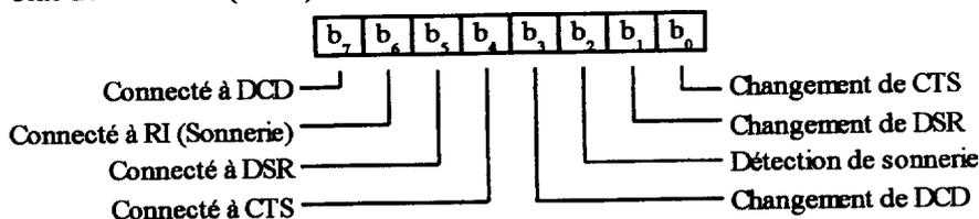
Les bits 0,1 et 3 sont respectivement associés aux entrées CTS, DSR et DCD. Lors d'un changement de niveau sur une de ces trois entrées le bit correspondant est positionné à 1. Par contre le bit 2 qui est associé à l'entrée de détection de sonnerie du modem (entrée RI), n'est positionné à 1 que lors de l'apparition d'un front montant sur cette entrée. Ces quatre bits sont mis à 0 après la lecture du registre d'état du modem par le microprocesseur.
