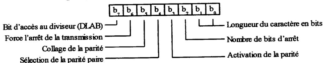
La longueur du caractère transmis est déterminé par les deux bits de poids faible et est réglable entre 5 et 8 bits. Le tableau A1.4 montre les diverses possibilités de réglage du nombre de bits. Le nombre de bits d'arrêt est aussi paramétrable et dépend de la valeur du bit 2 mais aussi de la taille du caractère transmis comme le montre le tableau A1.5.
