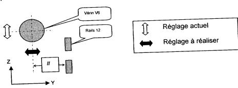
Pour permettre le calage des extrémités du vérin V6 suivant l'axe Y, il faut modifier la position de la plaque 105, sans la modifier, et adapter la forme de la plaque 103.
