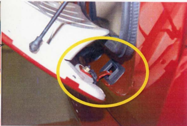
Les articulations, les amortisseurs et l'abattant supportent 75 kg pour un cahier des charges de 40 kg.
