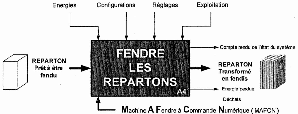
Cette machine ① est approvisionnée par des repartons placés sur des plateaux ②. Chacun de ces ensembles (plateau + reparton) sont acheminés par un convoyeur accumulateur ③. Après fendage du reparton par la MAFCN, il en sort des fendis ④.
