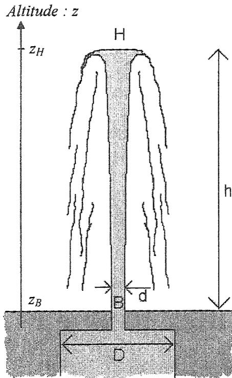
L'eau prélevée dans le lac est envoyée à l'aide de deux groupes moto-pompes sous une pression  $p = 15$  bar dans une conduite de diamètre  $D$ . Elle passe ensuite en B, qui est au niveau de la surface du lac, d'altitude  $z_B$  dans une buse d'éjection de diamètre  $d = 107$  mm.
