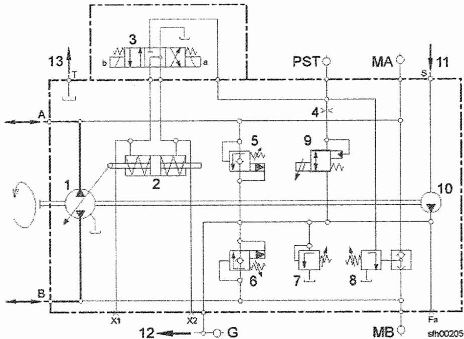
Schéma hydraulique de la pompe à débit variable
